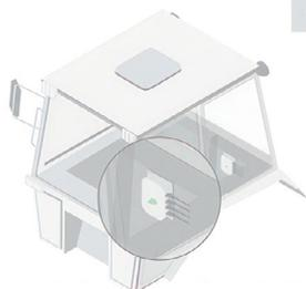
Рисунок 27 – Профиль техники – Положение коммутатора
